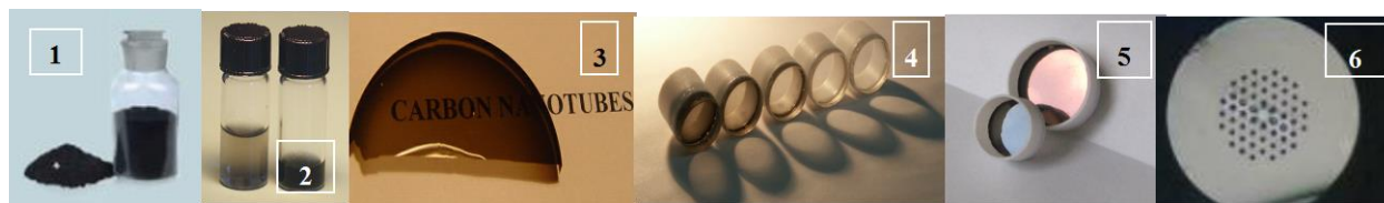
Рис.1. Различные типы насыщающихся поглотителей на основе одностенных углеродных нанотрубок для волоконных лазеров : 1- исходная сажа, содержащая ОУН; 2- водная суспензия оптического качества, содержащая индивидуальные углеродные нанотрубки; 3- полимерная пленка из карбоксиметилцеллюлозы с распределенными в ней ОУН; 4- пленки с ОУН на кварце (полученные по такой же технологии, как на фото 3) с одинаковой толщиной и различной оптической плотностью; 5- лазерное зеркало, покрытое полимерной пленкой с распределенными ОУН; 6- дырчатое волокно с внутренними поверхностями дырок, покрытыми пленкой из ОУН.
