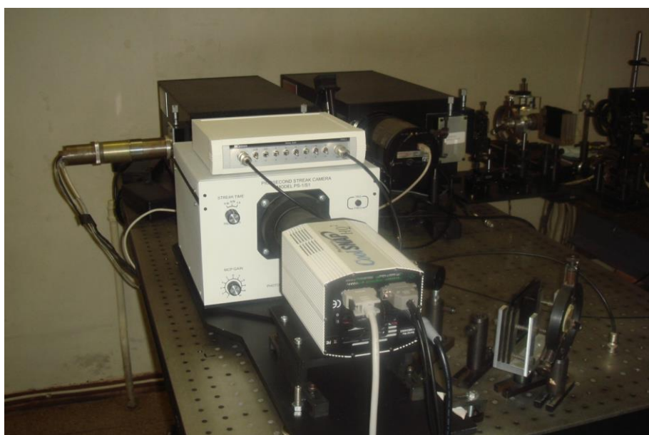
Рис. 1 Пикосекундная стрик-камера модели PS-1/S1 в составе спектрохронографического измерительного комплекса ИРЭ РАН по исследованию динамики стимулированного излучения из GaAs [6].
